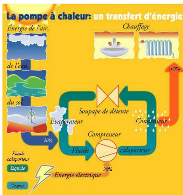
Figure 65 : principe de fonctionnement des pompes à chaleur (source www.airclim-concept.com )
